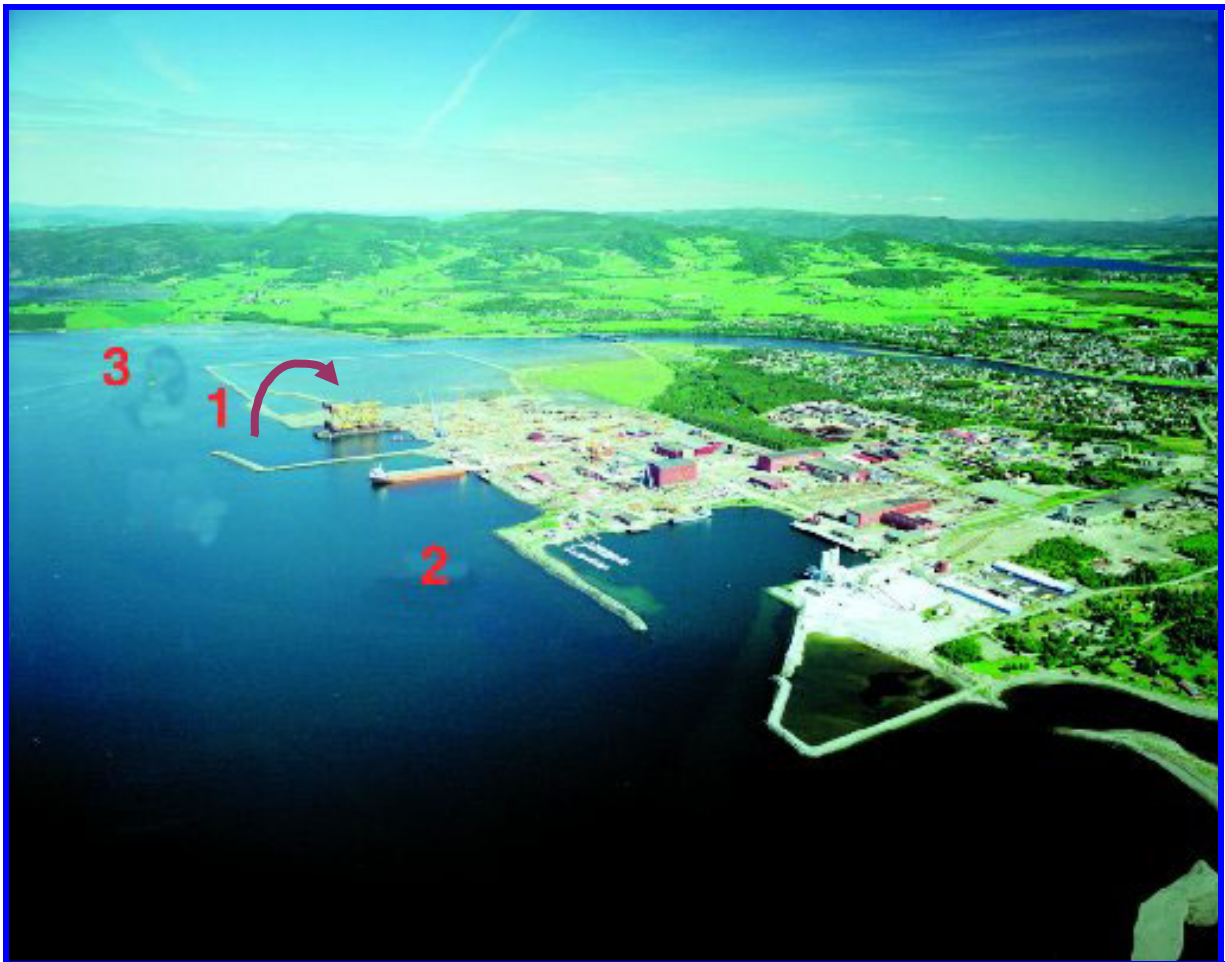
Figur 3.1. Foreslåtte masseuttak i forbindelse med melding om tiltaket. 1 = Hovedtiltak, mudring og deponering av marin masse; 2 = Mudring for dypvannskai; 3 = Privat masseuttak i utløpet av Verdalselva.
